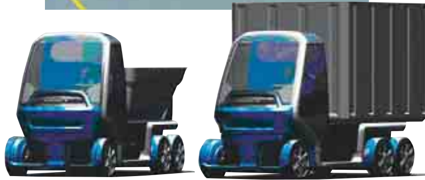
De multifunctionele Host-wagen wordt vlotjes omgebouwd van personenwagen tot taxibusje, vrachtwagen of vuilniswagen, zodat het onderstel nooit werkloos langs de kant staat. Een lopende band voert de modules aan vanuit een opslagplaats. © Host
