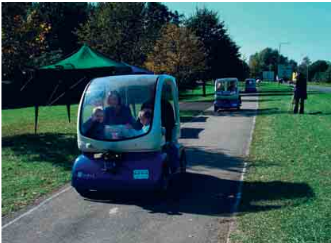
Robot-wagentjes kunnen dankzij ingebouwde laserscanners obstakels zien aankomen. © CityMobil
