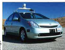
Sur le toit, le système de détection et de représentation spatiale.
